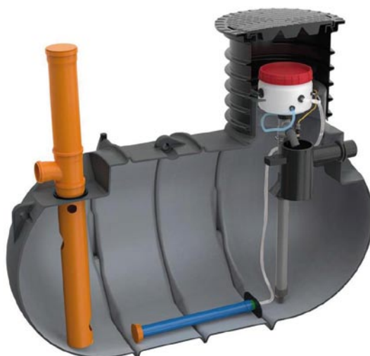
4. Przekrój oczyszczalni SBR pracującej w wariancie I – ciągły dopływ ścieków, bez komory uśredniającej. Źródło: rewatec.de
